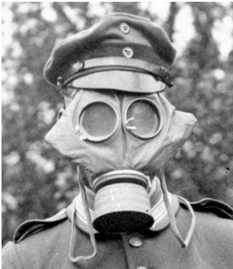
Fig. 3. La prima maschera antigas costituita da un facciale a pieno viso in tela gommata e da un filtro smontabile e sostituibile.
