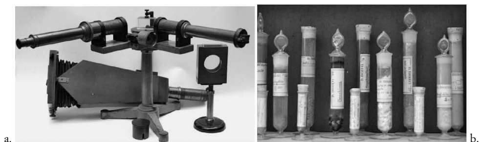
Fig. 1. a. Spettroscopio a prisma dei primi del Novecento con camera oscura e vaschetta portacampione per l'analisi delle soluzioni; b. Alcuni coloranti organici degli anni venti della Collezione Bigiavi.
