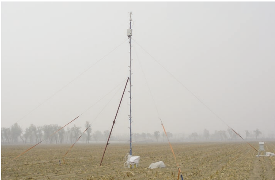
Fig. 3. Strumento basato sulla tecnica eddy covariance per la misura dell'erosione eolica.
