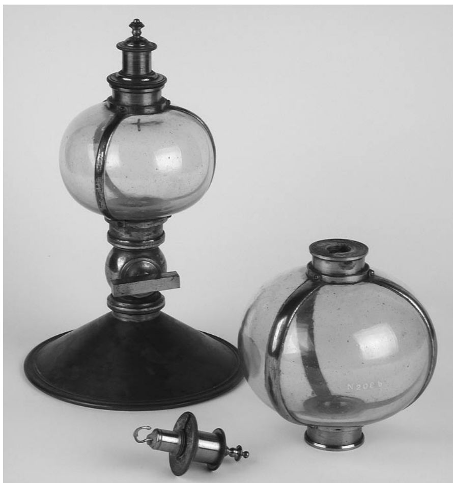
Fig. 6. Camere di combustione dell'eudiometro «comparabile» appartenenti alla collezione pavese di strumenti voltiani (Museo per la Storia dell'Università di Pavia).
