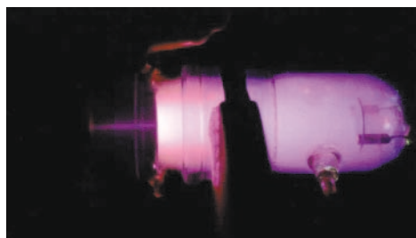
Fig. 19. Fascettino di raggi canale evidenziato nel tubo a raggi catodici. Il catodo ora è a sinistra.
