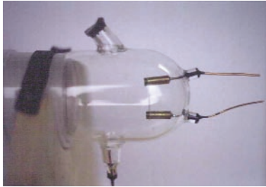
Fig. 8. Parte di emissione del tubo a raggi catodici.
