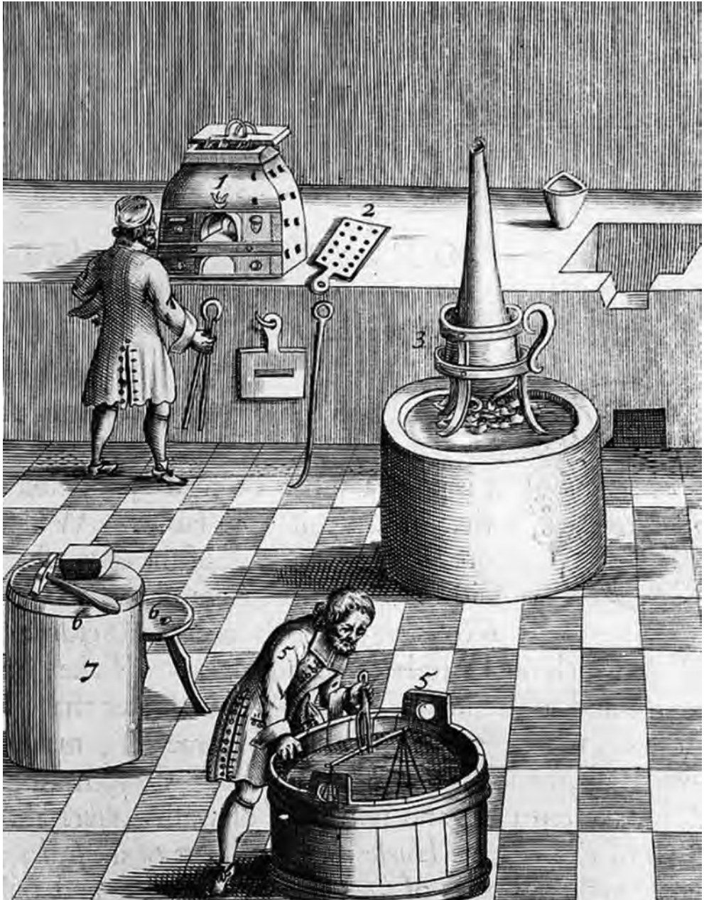
Fig. 1. Nella parte inferiore della xilografia è raffigurato un operatore intento nella determinazione del titolo dell'oro mediante il metodo della densità. Nel caso specifico, il saggio viene condotto con l'ausilio di una bilancia completamente immersa in acqua [2].
