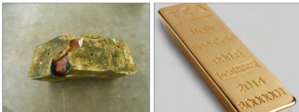
Fig. 2. A sinistra, esempio di adulterazione di una barra d'oro al cui interno è presente una «saponetta» di rame. In questo caso, a differenza di quello con tungsteno, il metodo della densità è in grado di rivelare la truffa. A destra, esempio di lingotto d'oro perfettamente conforme allo standard « Good Delivery ». Diffusione delle foto acconsentita da TCA S.p.A.
