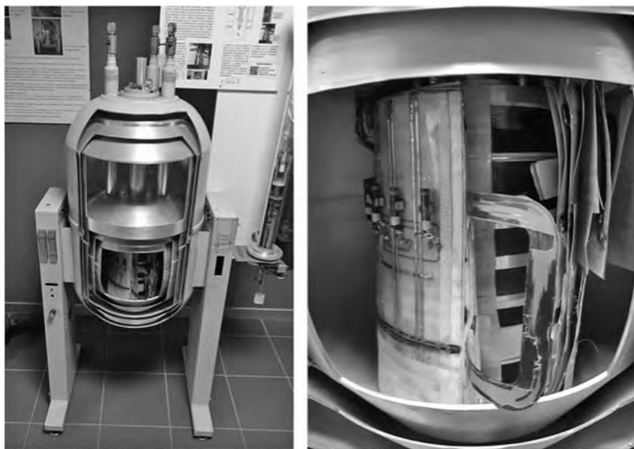
Fig. 4. A sinistra. Strumento di Risonanza Magnetica Nucleare Varian VXR300, sezionato a scopo didattico e corredato di pannelli esplicativi. A destra. Ingrandimento del solenoide superconduttore e delle bobine di shimming (ben visibili sulla sinistra).
