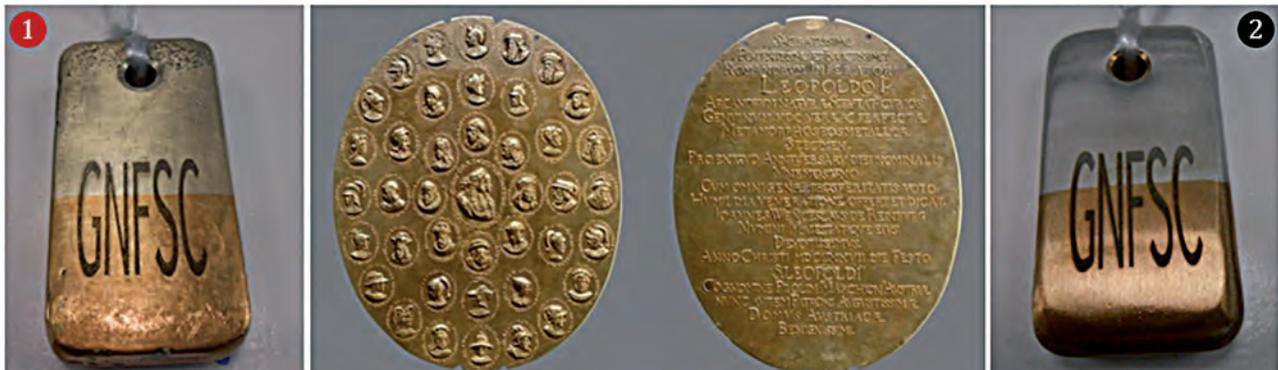
Fig. 1. A sinistra trattamento con acido nitrico su un campione 1 costituito da una lega della stessa composizione del medaglione di Seiler, al centro vista di ambo i lati del medaglione ed infine a destra trattamento con acido su un campione 2 in lega binaria  $Au_{40\%}-Ag$ .
